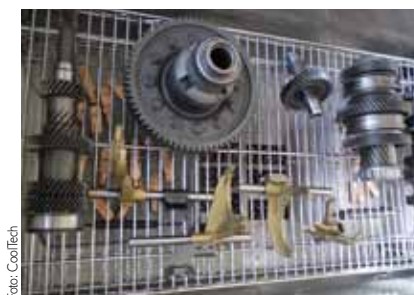
Tieftemperaturbehandlung reduziert den Verschleiß und steigert die Motorleistung.
